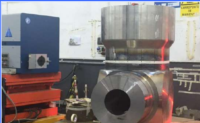
Controllo RT con acceleratore lineare su saldatura spessore oltre 300mm
