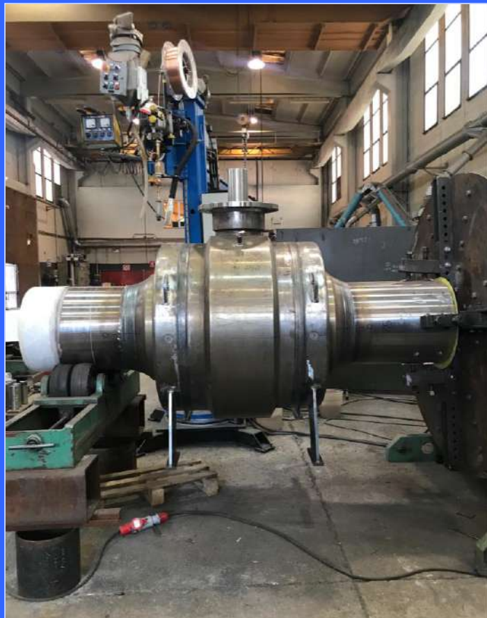
Valvole a sfera: acciaio al carbonio e acciaio basso legato Ball valve made of carbon steel and low alloy steel.
