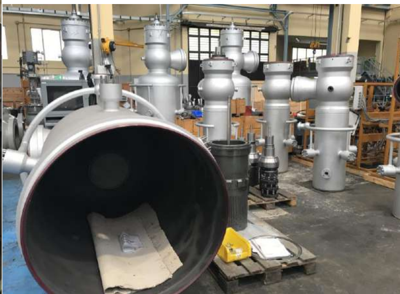
Valvole a sfera: acciaio al carbonio e acciaio basso legato Ball valve made of carbon steel and low alloy steel.
